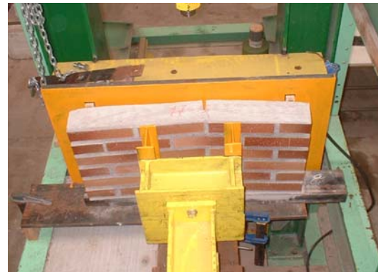
Figura 18: Ensayo de flexión perpendicular a tendeles de una fábrica cerámica
