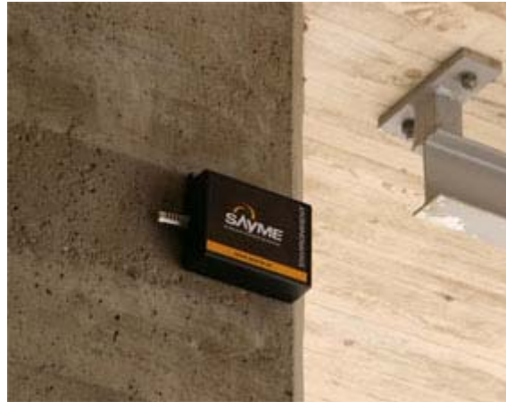
Figura 3. Fotografía de un Módulo Sensor de Temperatura y Humedad.
