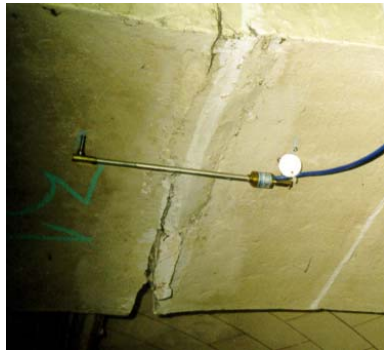
Figura 28: Extensómetro. Cortesía: LABEIN. Figura 29: Clinómetro. Cortesía: LABEIN.
