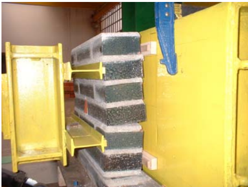
Figura 17: Ensayo de flexión paralela a tendeles de una fábrica cerámica
