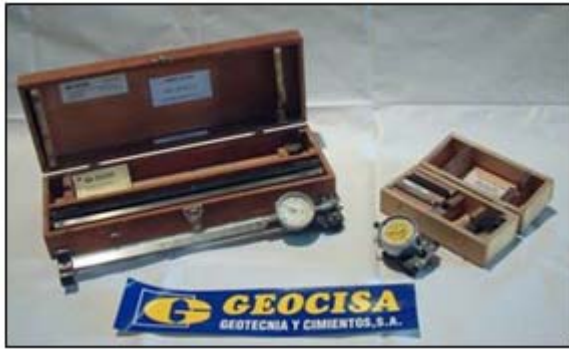
Figura 2.- Extensómetros mecánicos y de cinta de invar.
