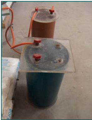
Figura 8: Cámaras de vacío para la saturación de muestras. Cortesía: LADICIM.
