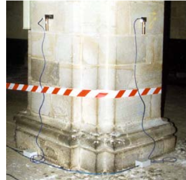
Figura 28: Extensómetro. Cortesía: LABEIN. Figura 29: Clinómetro. Cortesía: LABEIN.
