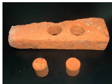
Figura 6: Testigos extraídos por perforación cilíndrica en dos distintos tipos de ladrillo.
