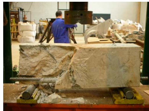
Figura 20: Ensayo para determinar la carga máxima a flexión en una probeta pétrea natural armada, frente a mecanismos de rotura a flexión y cortante, con acero inoxidable y mortero
