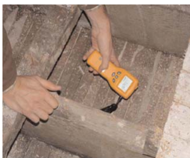
Figura 16: Determinación del contenido de humedad en madera mediante xilohigrómetro.
