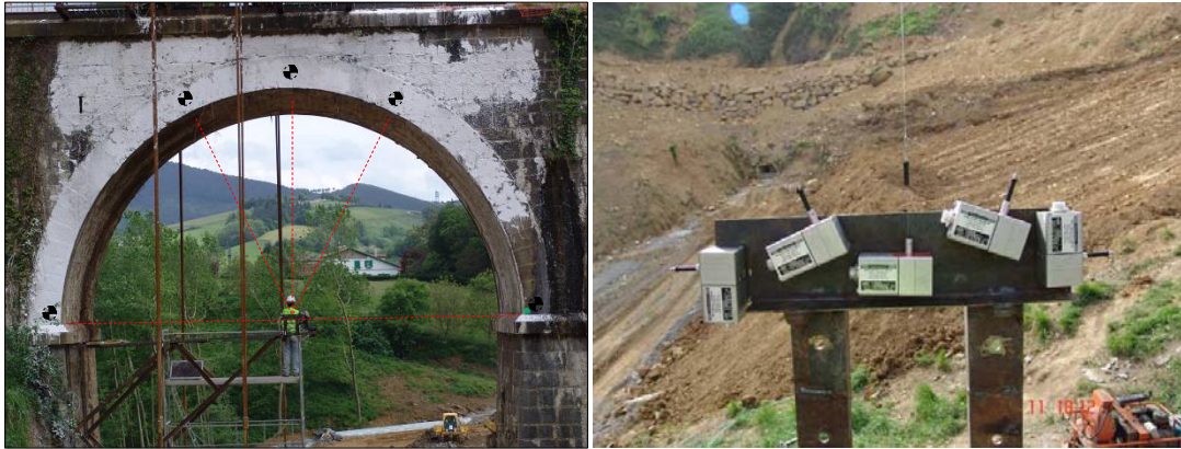
Figura 9: Izquierda, disposición de los puntos para toma de deformaciones de la bóveda durante la prueba. Derecha, detalle de disposición de los potenciómetros lineales.
