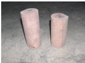
Figura 3: Testigos de roca arenisca
