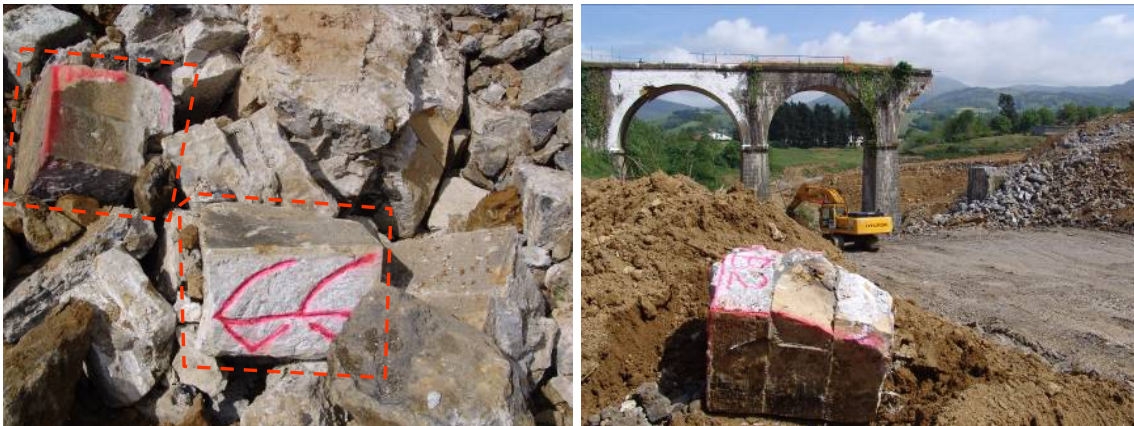
Figura 17. Vista de muestras seleccionadas para ensayos mecánicos.
