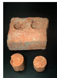
Figura 6: Testigos extraídos por perforación cilíndrica en dos distintos tipos de ladrillo.
