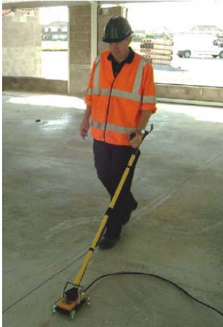
Figura 3: Fotografía del operador trabajando con la antena de 1.6GHz y el monitor XV11
