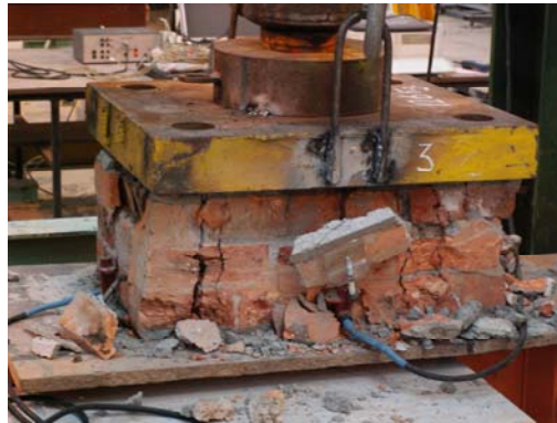
Figura 15: Ensayo en laboratorio a compresión de una probeta de fábrica antigua extraída de la construcción original
