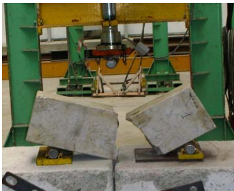
Figura 19: Ensayo para determinar la carga máxima a flexión en una probeta pétrea natural.
