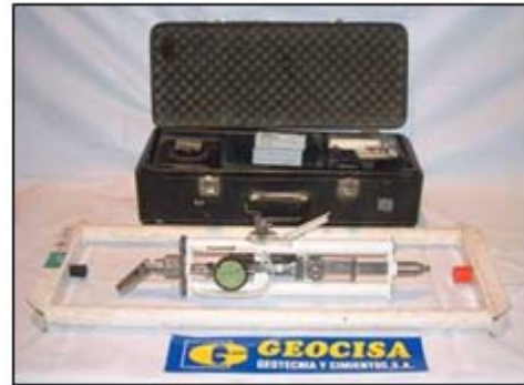
Figura 2.- Extensómetros mecánicos y de cinta de invar.
