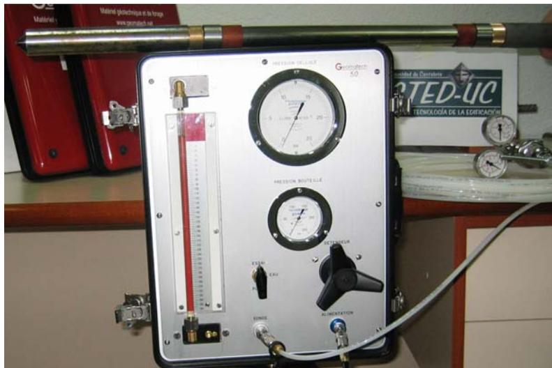
El procedimiento de ensayo (figura 9) consiste en taladrar una perforación, cuidando de reducir al mínimo la perturbación en la pared, con un diámetro compatible con el tamaño de sonda a introducir. A partir de las lecturas del ensayo, presión suministrada por la sonda e incremento de volumen, puede obtenerse la curva presión – volumen inyectado, de la que puede estimarse el módulo de deformación de la fábrica.
