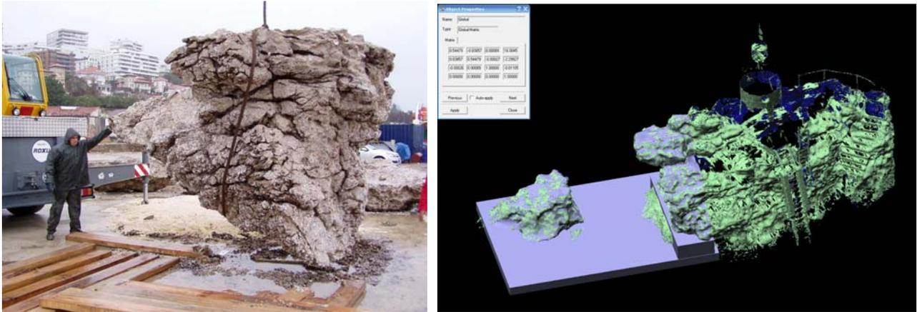
Una vez terminada la interpretación y depuración de los datos obtenidos mediante el escaneo de las piezas, se procedió a trabajar sobre esos datos para proporcionar una maqueta 3D (E: 1/40) de la isla y de los fragmentos para la reintegración de la morfología primitiva.
