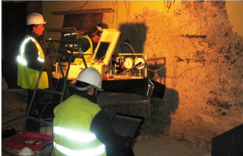
Mediante incrementos graduales de la presión puede determinarse la relación entre tensión y deformación. También pueden simularse ciclos de carga-descarga.
