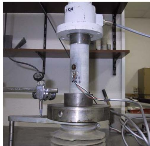
Sobre las muestras se realizaron ensayos de identificación (ensayo petrográfico con láminas delgadas), resistentes y deformacionales (ensayos de compresión simple con galgas extensométricas, ensayos de tracción indirecta - Brasileño) y de alterabilidad o durabilidad (ensayos de absorción de agua y Slake Durability Test).
