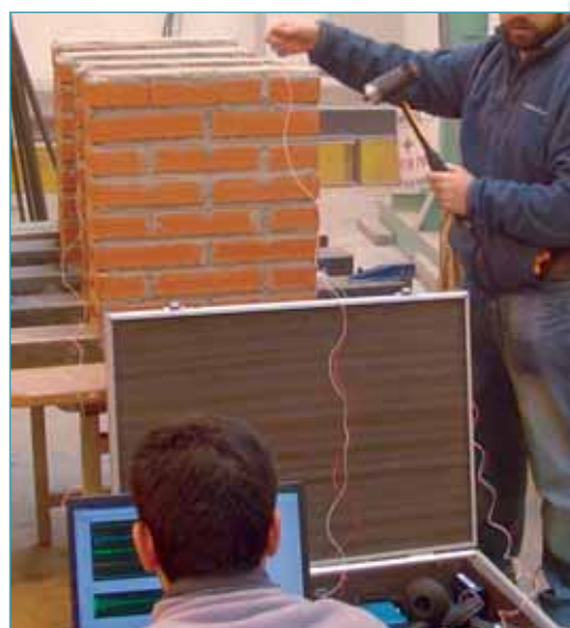
Figura 5 - Imagen de la auscultación sónica mediante equipo sónico multicanal en el Laboratorio de Estructuras de la UC (Colaboración GTED - AIDICO)
