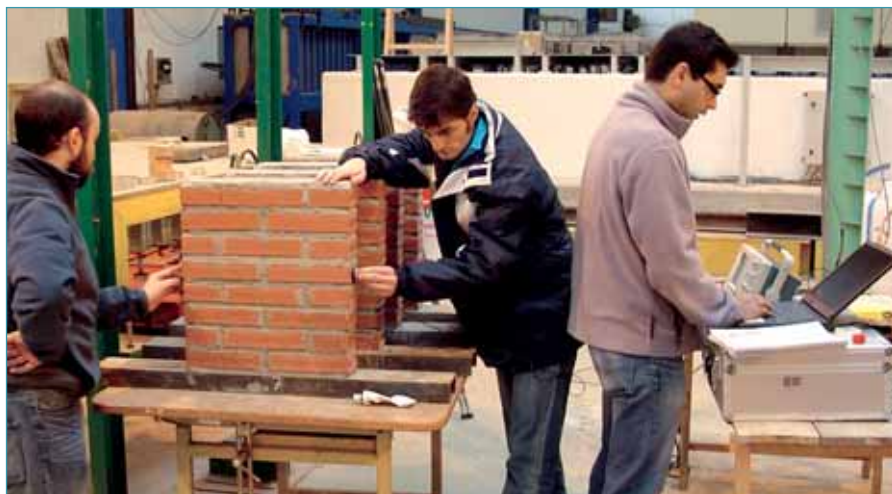
Figura 4 - Medida por ultrasonidos realizada sobre un murete de ladrillo en el Laboratorio de Estructuras de la UC (Colaboración GTED - AIDICO)
