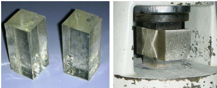
Figuras 1: Probeta de resina tras el ensayo de flexión.
