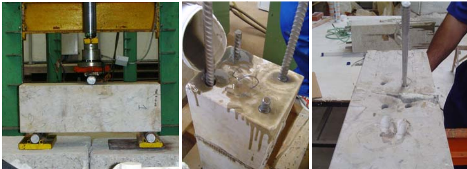
Figuras 7: Ensayo a flexión de una probeta de roca caliza.
