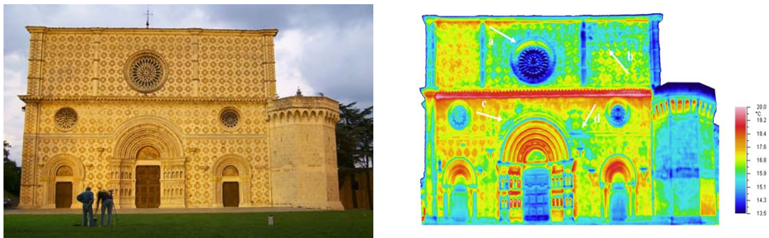
Figura 8: Aplicación de termografía infrarroja en la Basilica di Santa Maria di Collemaggio L'Aquila. (Fuente: Università degli study di L'Aquila, Dipartimento di energetica)
