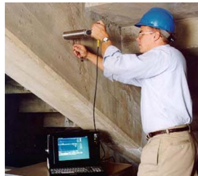
Figura 6: Equipamiento de un ensayo de impacto-eco. (Fuente: N. J. Carino).
