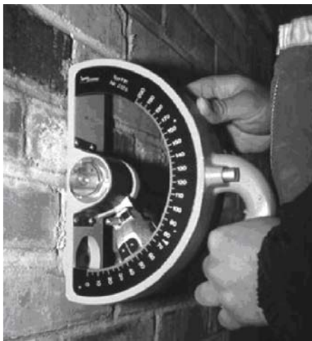
Figura 7: Esclerometría de rechazo. (Fuente: G. Crocci)
