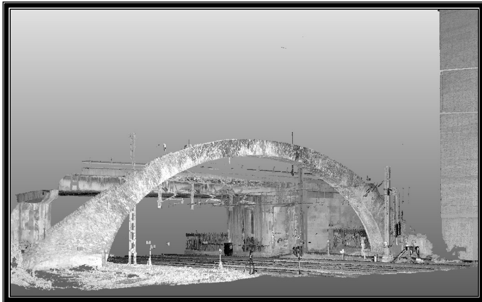
Fig 1: Vista en perspectiva de la nube de puntos del Arco de Ladrillo.
