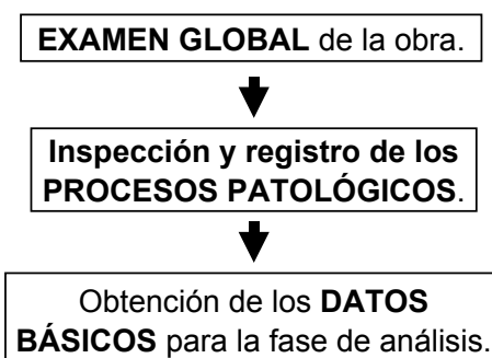
Figura 10 - Etapas en la fase de reconocimiento de una obra a rehabilitar.
