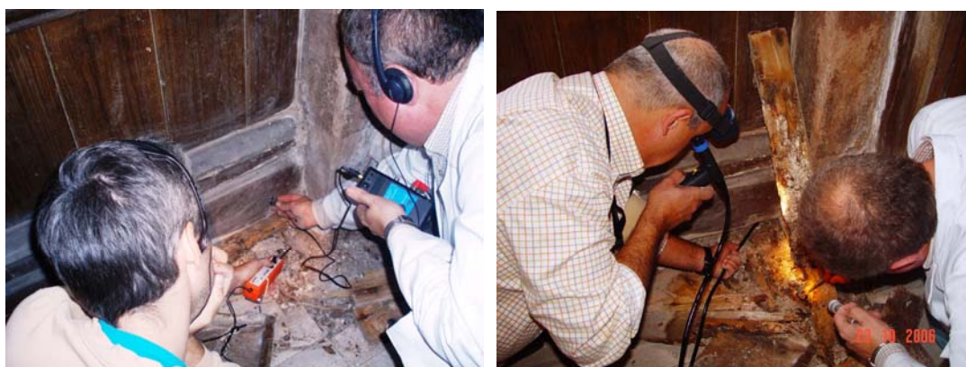
Figuras 15 - Ensayos no destructivos (END) en elementos de madera: Escucha de sonidos para investigar la actividad de insectos xilófagos (izq.) e inspección de huecos a través de endoscopio (dcha.): Cortesía de Montañesa de desinfección, S.L.
