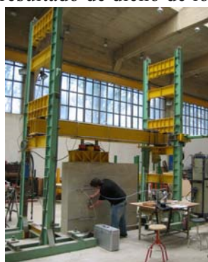
Figura (5): Instante de un ensayo de gato plano doble
