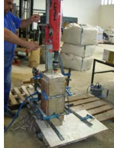
Figura (10): Perforación para inserción de anclajes
