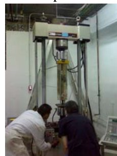
Figura (8): Instante de un ensayo a fatiga de un anclaje (Ladicim-UC)
