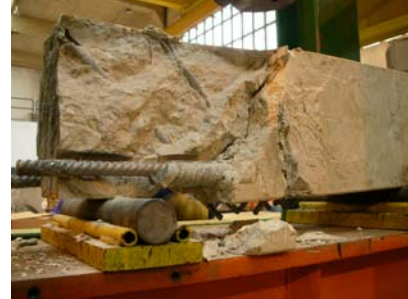
Figura (11): Detalle de la rotura a flexión del prisma de la figura (15) una vez reforzado.
