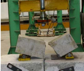
Figura (9): Rotura a flexión de un prisma de roca natural (Gted-Labest-UC)
