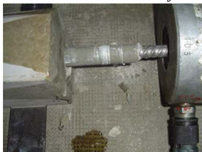
Figura (7): Detalle de la rotura de un anclaje durante un ensayo a tracción (Gted-Labest-UC)
