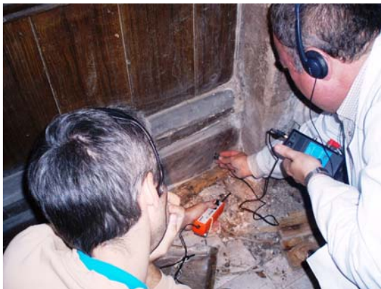
Figuras 17: Ensayos no destructivos (END) en elementos de madera: Escucha de sonidos para investigar la actividad de insectos xilófagos (izq.) e inspección de huecos a través de endoscopio (dcha.): Cortesía de Montañesa de desinfección, S.L.
