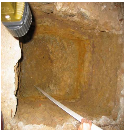
Figuras 8: A la izquierda se recoge un pozo realizado junto a un muro de carga (para conocer el tipo de terreno de cimentación y la profundidad del NF). A la derecha se muestra un aspecto de la constitución del citado muro (una fábrica de ladrillo macizo).
