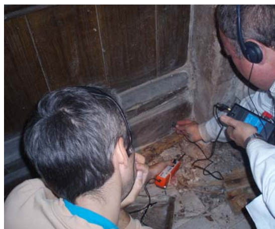
Métodos sónicos para la determinación de actividad de los hipotéticos organismos xilófagos. Cortesía Montañesa de Desinfección.
