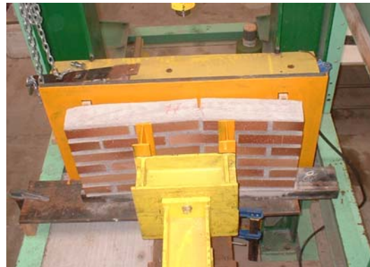
Figura 18: Ensayo de flexión perpendicular a tendeles de una fábrica cerámica
