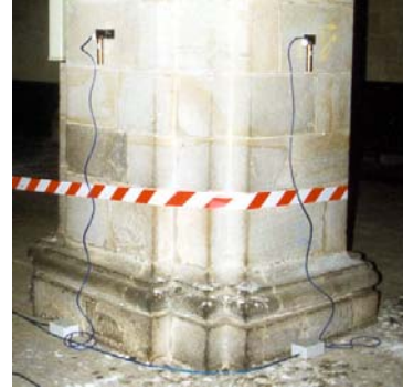
Figura 28: Extensómetro. Cortesía: LABEIN. Figura 29: Clinómetro. Cortesía: LABEIN.
