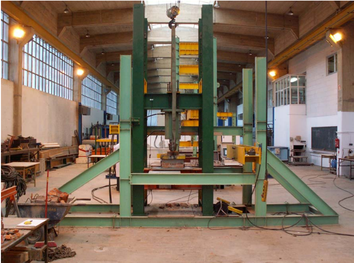
Figura 14: Configuración general de un ensayo a compresión sobre una probeta de fábrica antigua de ladrillo macizo.
