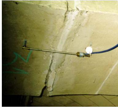
Figura 28: Extensómetro. Cortesía: LABEIN. Figura 29: Clinómetro. Cortesía: LABEIN.
