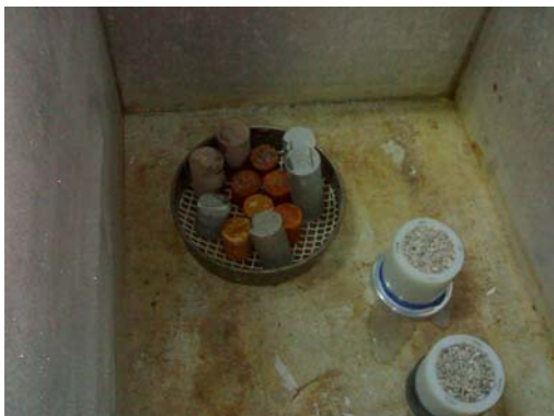
Figura 12: Testigos en el interior de la cámara frigorífica durante los ensayos de heladicidad. Cortesía: LADICIM.
