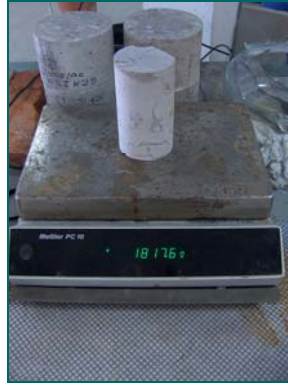
Figura 8: Pesado de muestras en balanza de precisión. Cortesía: LADICIM.
