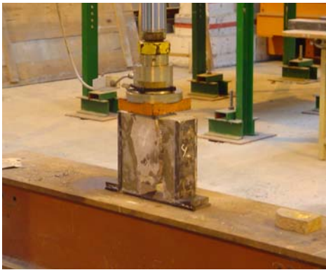
Figuras 21 y 22: Ensayo para evaluar la tensión de adherencia a cortante entre una piedra caliza natural y un mortero polimérico epoxi
