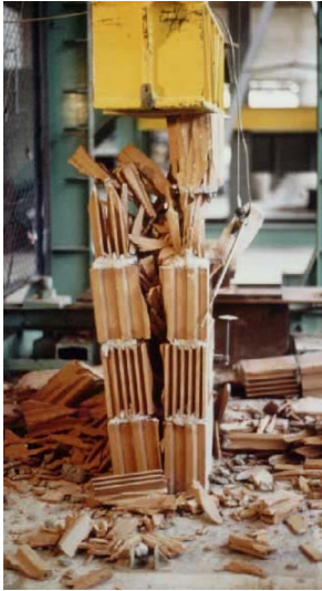
Figura 14: Ensayo a compresión de una fábrica cerámica
