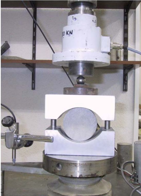
Figura 10: Ensayo brasileño (tracción indirecta) de un testigo de piedra caliza.
