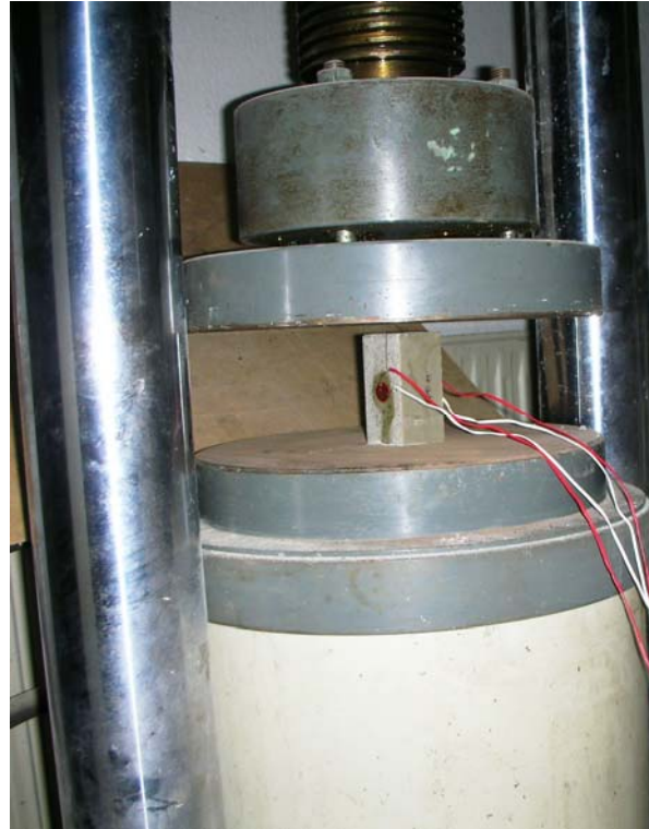
Figura 11: Ensayo para la obtención del módulo de elasticidad y coeficiente de poisson de un mortero polimérico epoxi.
