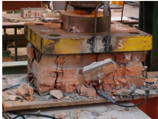
Figura 15: Ensayo en laboratorio a compresión de una probeta de fábrica antigua extraída de la construcción original
