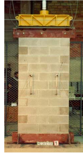
Figura 16: Ensayo a compresión de una fábrica de bloques
