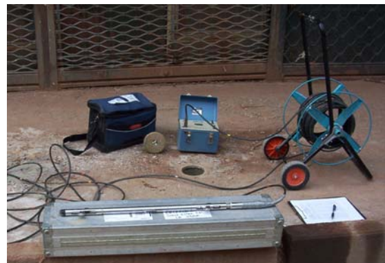
Figura 27: Torpedo inclinométrico con electrónica de medida
