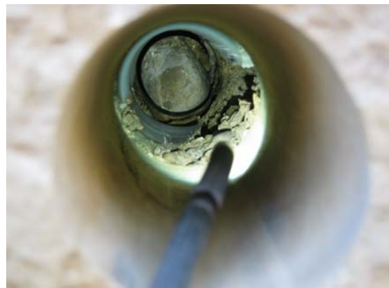
Figura 4: Videoscopia a través de una perforación realizada en un mampuesto para obtener un testigo para ensayo en laboratorio.
