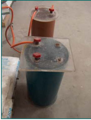
Figura 8: Cámaras de vacío para la saturación de muestras. Cortesía: LADICIM.
