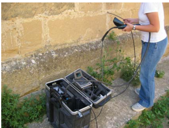
Figura 3: Videoscopia a través de un agujero existente en una fábrica de arenisca.
