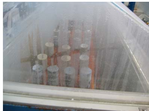
Figura 13: Probetas en cámara para ensayo acelerado de corrosión por niebla salina. Cortesía: LADICIM.
