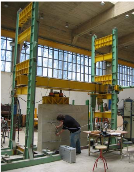
Figura 17. Resultado del ensayo, el módulo de elasticidad (E) estimado fue de 2,019.20 \text{ N/mm}^2 , y coeficiente de Poisson ( \nu ) de 0.17.
