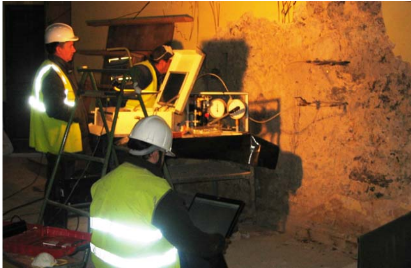
Figura 4. Ensayo de gato plano doble en el Seminario Mayor de Comillas, Cantabria.
