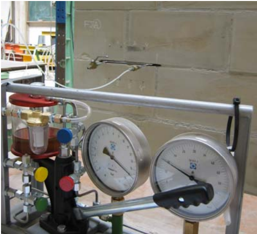
Figura 15. Resultado del ensayo, el nivel tensional determinado en este caso fue de 1.94 \text{ N/mm}^2 .
