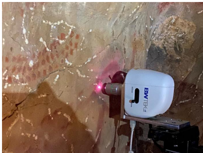
Figura 2. Uso de la plataforma tecnológica Raman portátil para análisis de la espeleotema y pigmentos de pinturas de La Cueva de La Pasiega (Puente Viesgo). Obsérvese que la sonda Raman está a una distancia de 3 cm de la muestra: análisis in situ no destructivo y sin contacto.
